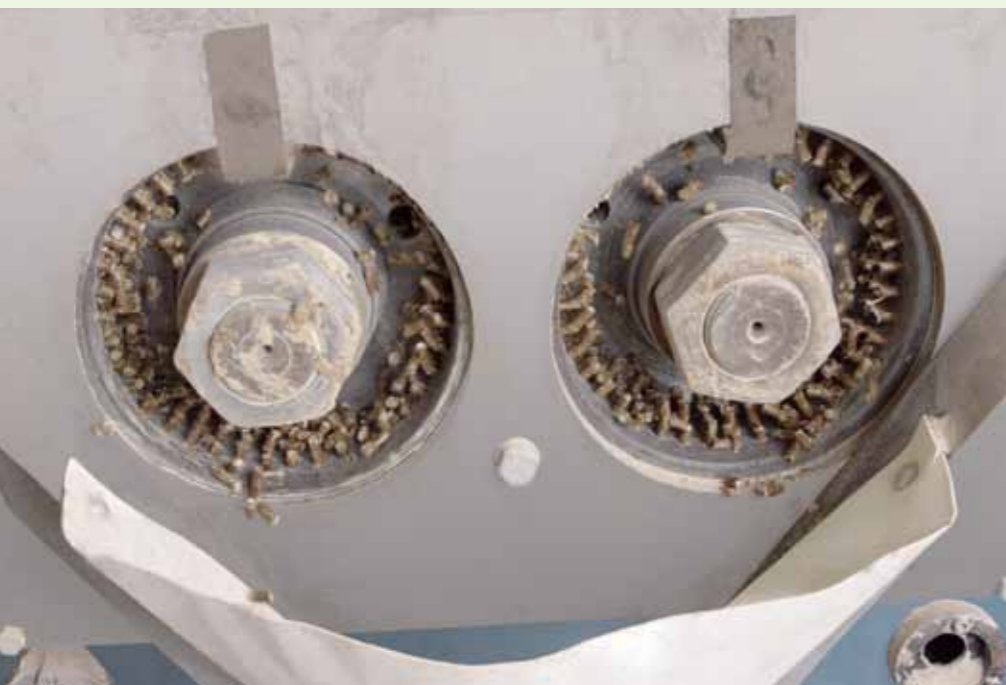
Pellet-Produktion: Zur besseren Lagerung oder anschließenden Verfeuerung kann der Trockenstoff direkt pelletiert werden.
